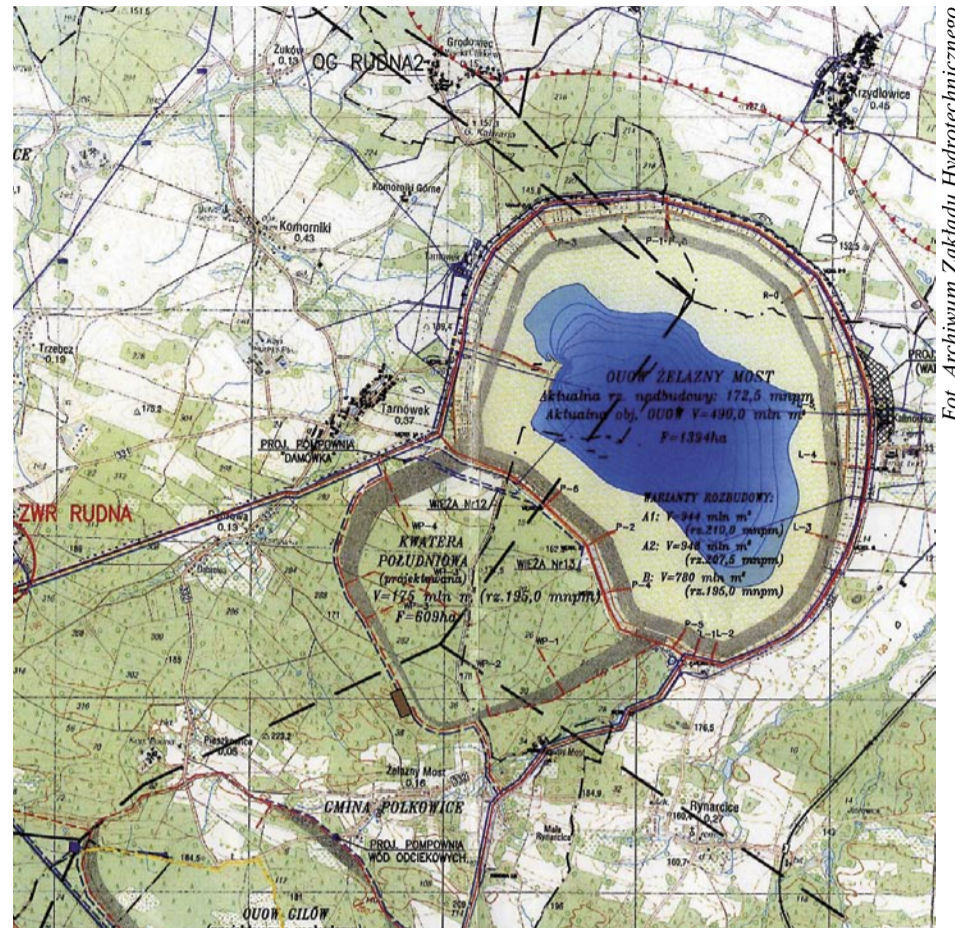
Kwaterna Południowa ma mieć 609 ha powierzchni. Wysokość zapór całego obiektu została ograniczona do rzędnej 195 m n.p.m.
