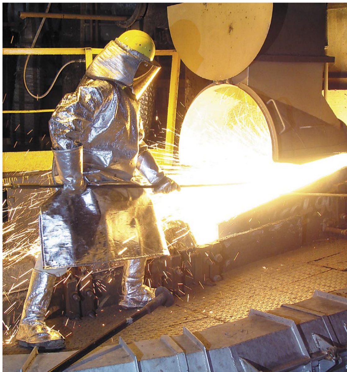
Przepalanie otworu spustowego pieca zawieszonowego po remoncie.
