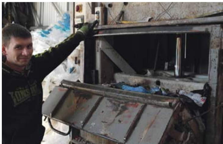
W tej maszynie odpady zgniata się i wiąże w bele, które pojadą do recyklera.
